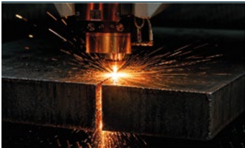
01 — CORTE LÁSER PESADO CORTE LÁSER FIBRA 12 KW 12 KW · MESA 1500x3000 · HIERRO HASTA 40MM
